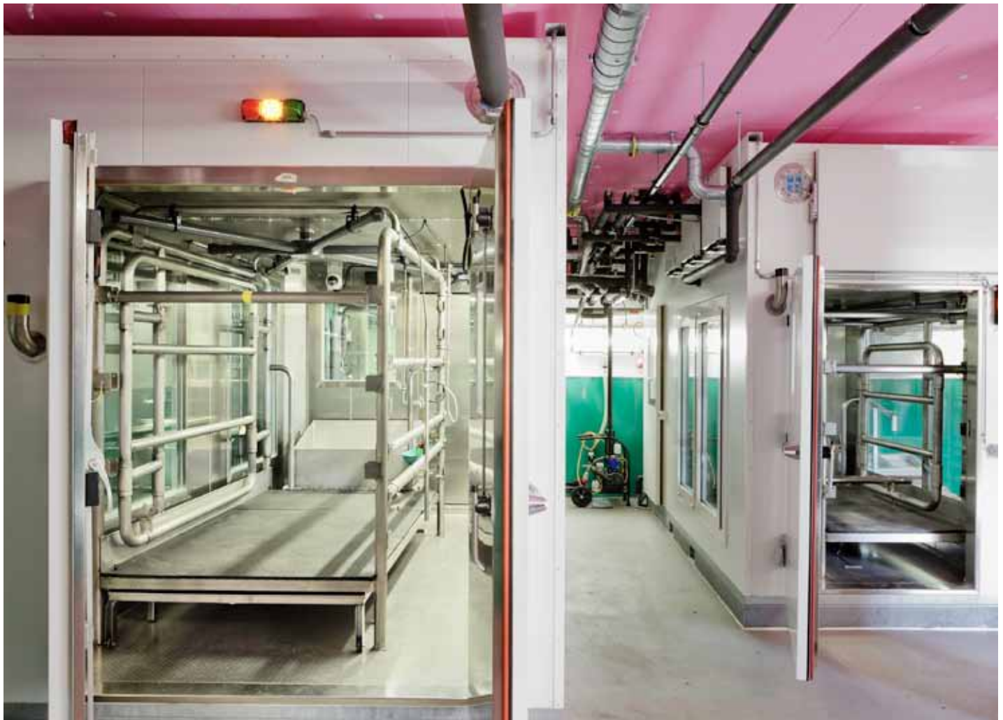
In den topmodernen Respirationskammern auf dem Strickhofareal lässt sich exakt messen, wie viel Gas Wiederkäuer produzieren und verbrauchen.
